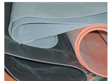
Tampons de pressage en caoutchouc de silicone supportés sur fibre de verre
